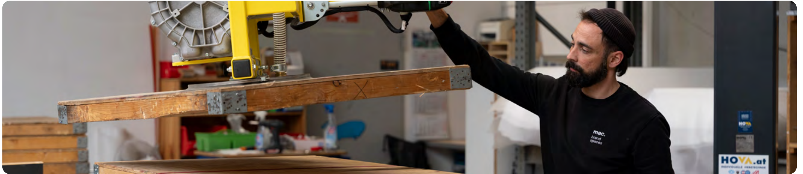
Hebkran zum sicheren Handling großer Holzplatten
