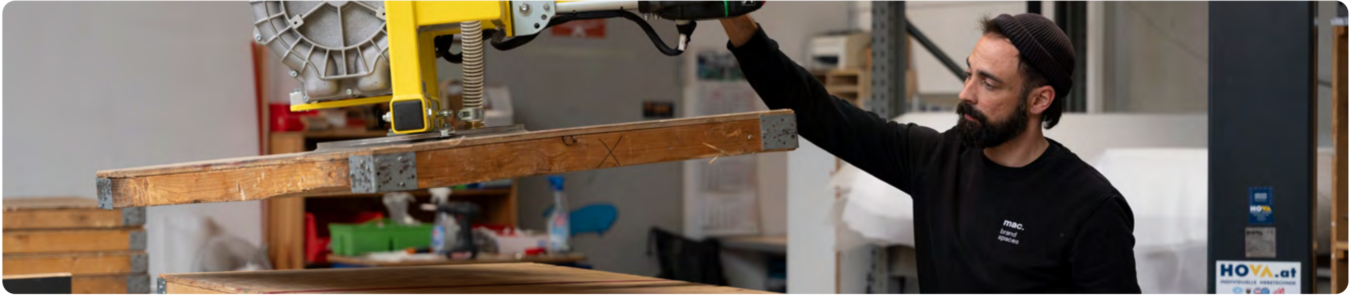
Hebekran zum sicheren Handling großer Holzplatten
